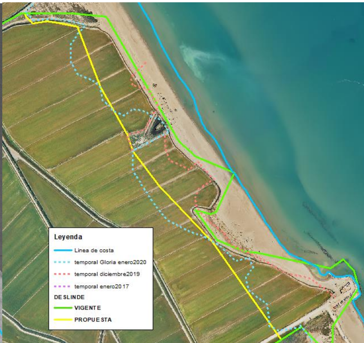
Comparativa 1. Comparación de la ortofotografía histórica más representativa (1983) con la ortofotografía actual (2021) en la Playa del Fangar. En esta comparación se observa la importante regresión que ha sufrido la costa comparando la imagen de 1983 con la línea de costa actual (línea azul). El retroceso de la playa se ha calculado entre 100m y 150m, según el tramo de playa. En esta misma comparación observamos también hasta donde se adentró la arena en los distintos temporales.
