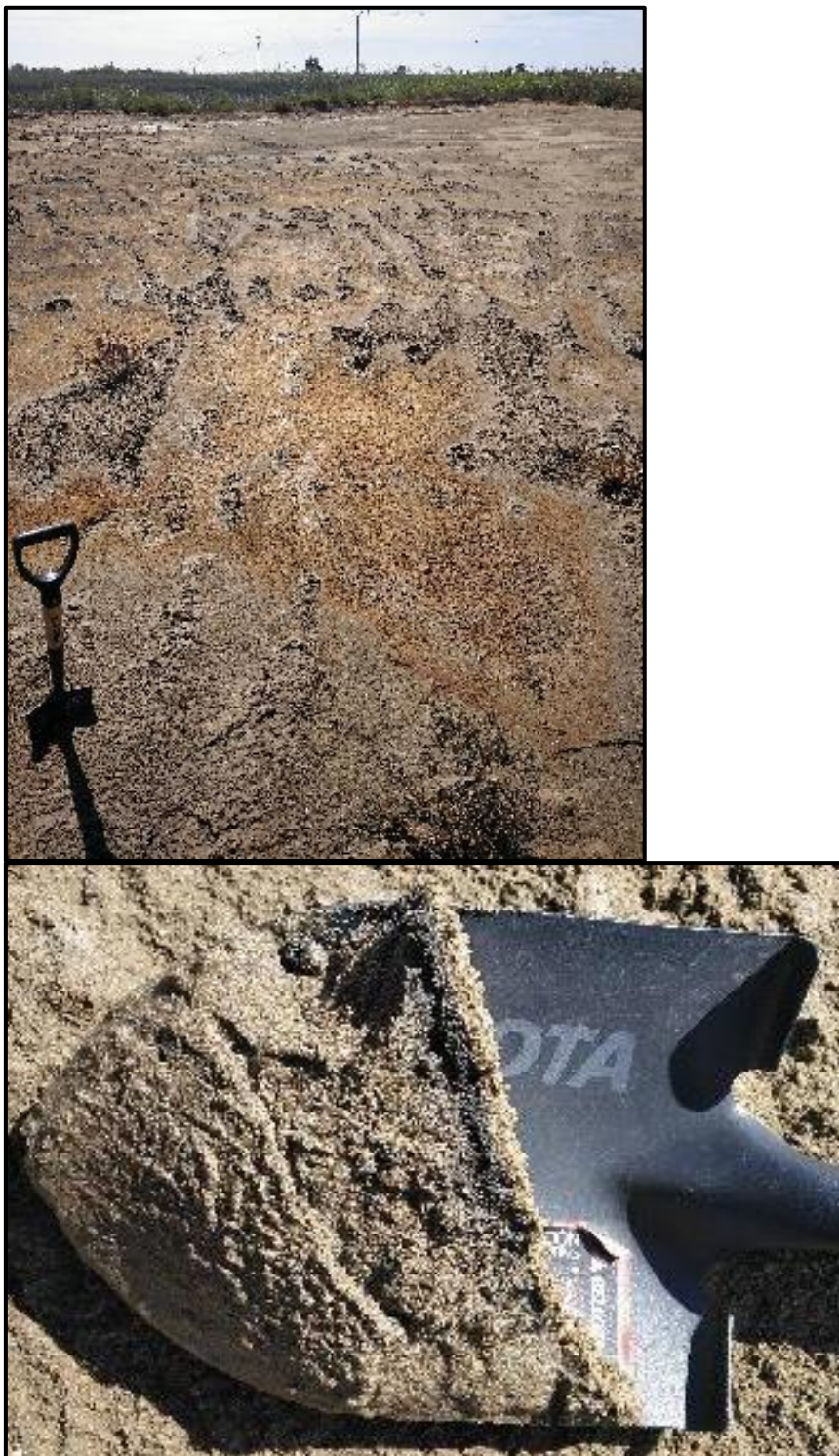
Imagen 33. Fotografía detalle de lo visto en campo. Arriba: terrenos con gran contenido en agua. Abajo: detalle de la muestra de cata
