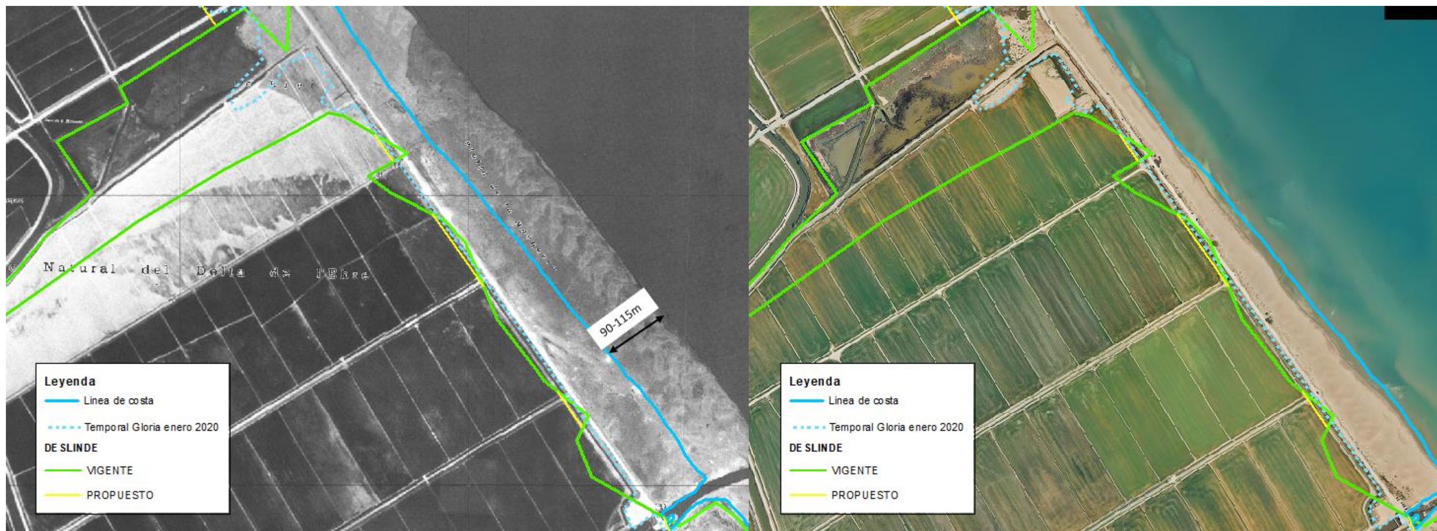
Comparativa 2. Comparación de la ortofotografía histórica (1983) más representativa con la ortofotografía actual (2021) en la Playa de la Marquesa. Se observa la importante regresión que ha sufrido la costa comparando la imagen de 1986 con la línea de costa actual (línea azul). El retroceso de la playa se ha calculado entre 90m y 115m, según el tramo de playa. En la imagen de la derecha observamos como la barra de arena que forma la playa se ha reducido a la mitad comparado con la que había en 1983.
